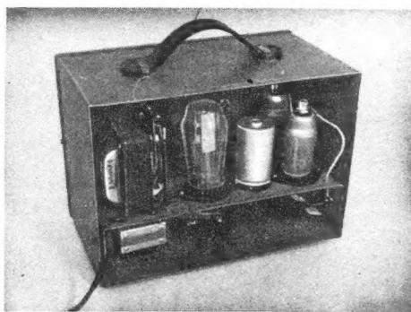
Bild 5. Innenaufbau des Frequenzwobblers
