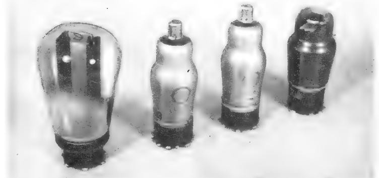
Bild 3. Die neuen Röhren UF 5, UF 6 und UL 2 im Größenvergleich zur Röhre AZ 11 (links)
